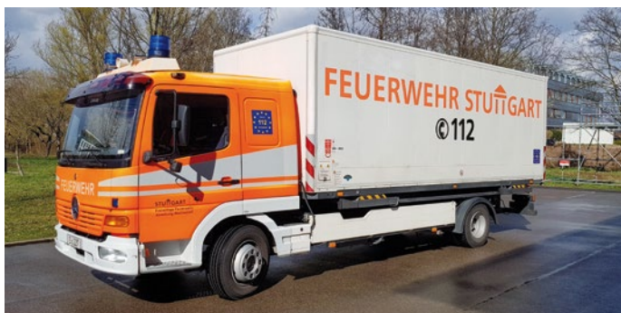
Einzelstück: Als Logistikfahrzeug dient dieser Mercedes-Benz Atego mit tauschbarem Wechselaufbau, den die Firma Wedau im Jahr 2000 baute.
