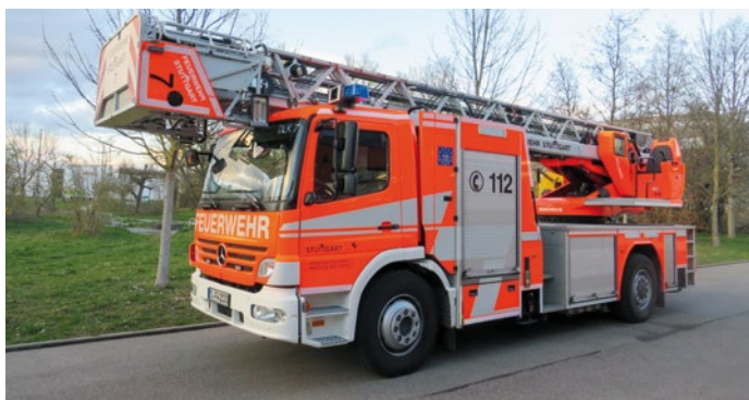
Drehleiter: Für Einsätze und zur Wachbesetzung nutzen die Freiwilligen diese Drehleiter, die Magirus auf einem Mercedes-Benz aufbaute.
