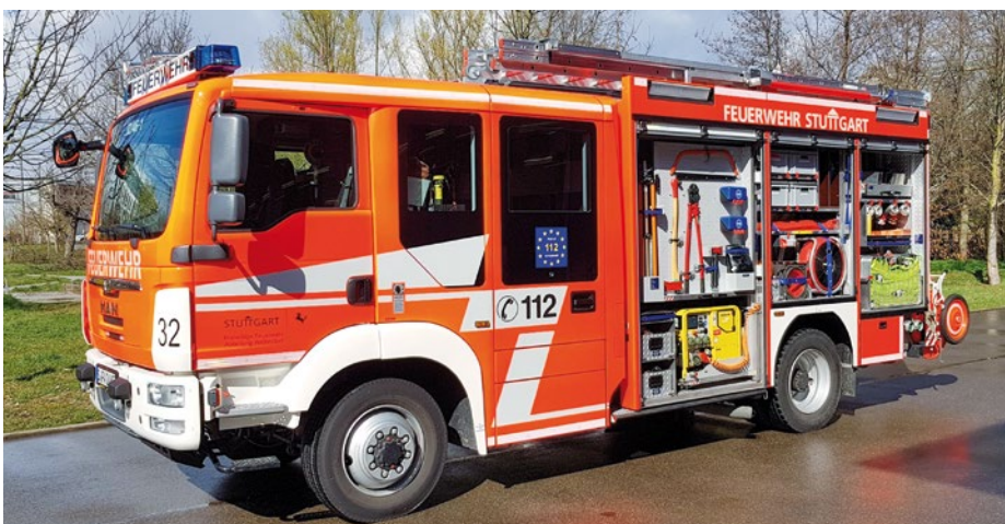
Im Stuttgarter Design: Das von Schlingmann auf einem MAN realisierte HLF 20 mit dem Funkrufnamen Florian Stuttgart 32/46-1.
